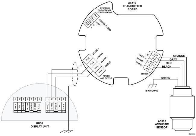
NOTES: DEVICE HOUSINGS MUST BE ELECTRICALLY CONNECTED TO EARTH GROUND.
